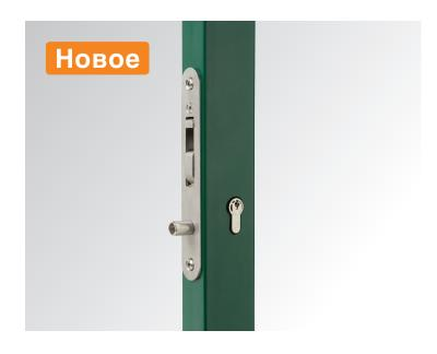
Врезной замок, выполненный на 100% из нержавеющей стали, с крюком для механического запирания (автоматических) раздвижных ворот. Отверстие для ручки - а значит, ручка - отсутствует для предотвращения использования её как ступеньки при перелезании через забор. Анти-саботажный штырь может легко быть снят для использования замка в распашных типах ворот.
